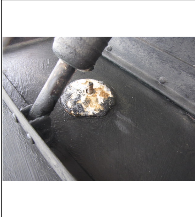
Port Trim tab zinc, photo 21.
